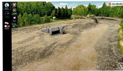
Thomas Nemetz' Innovation: Ein System aus Hard- und Software, das Unterwassergelände scannt und aus den so gewonnenen Daten dreidimensionale Untersee-Karten von Wasserkraftwerken generiert.
