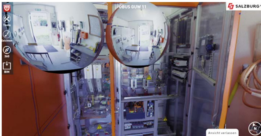
Bild 8. Digitalen Zwilling der Schaltzentrale einer O-Bus Station. 15
